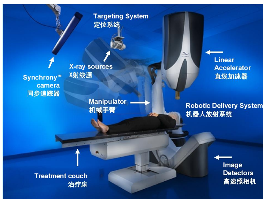
图 9-12 X 线立体定向放射治疗系统组成外形示意图
