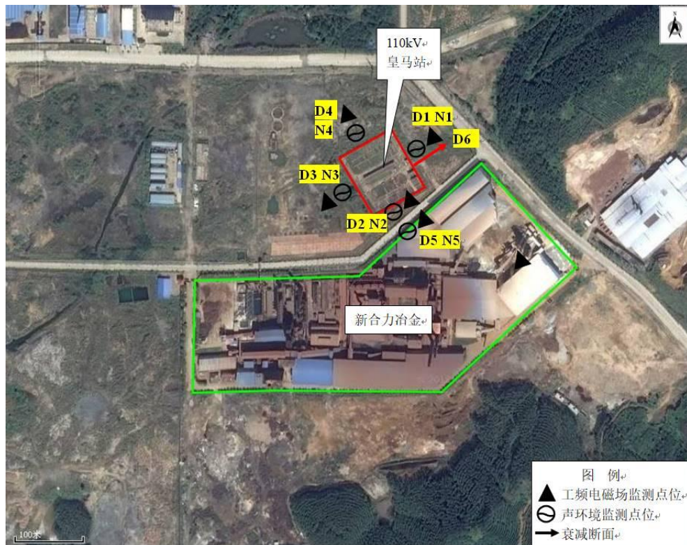
图 12 110kV 皇马变电站工频电场、工频磁感应强度监测布点示意图
