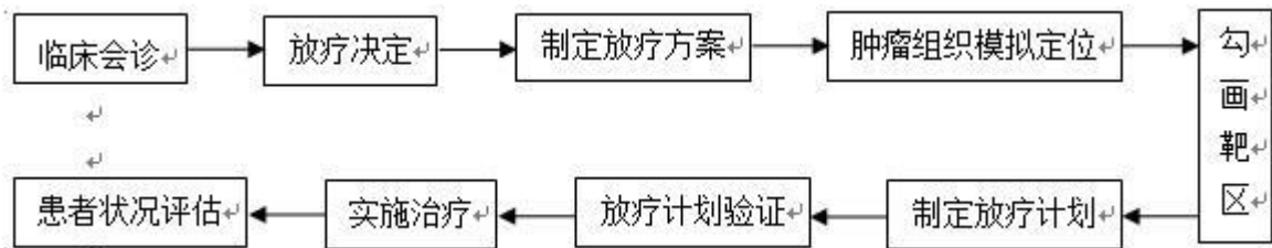
图 9-3 加速器放射治疗工作流程图
