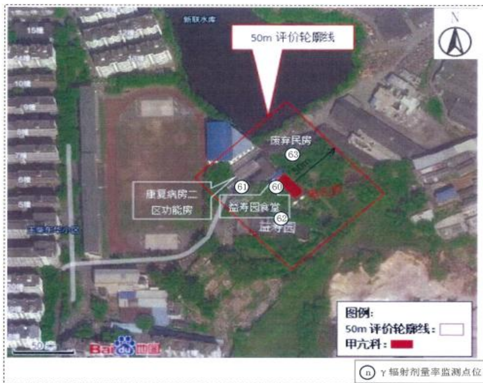
图 8-2 核医学科退役场所周围环境 \gamma 辐射空气吸收剂量率监测点位布置图
