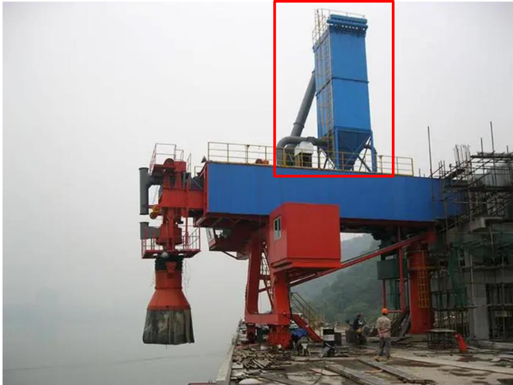
图 5.2.2-1 配备袋式除尘器的装船机示意图
