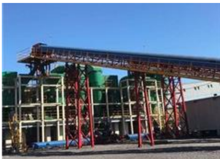
图 2.1.5-3 设备示意图（密闭带式输送机）
