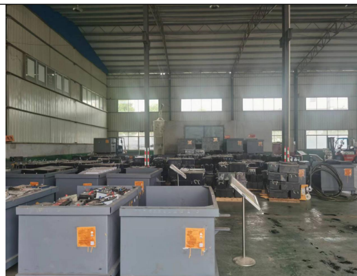
已建成废铅蓄电池贮存区
