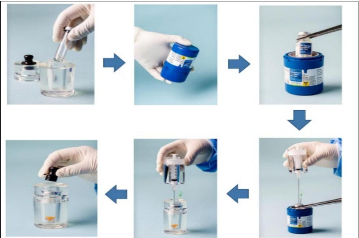
图 9-7 放射性药物  $^{90}\text{Y}$  微球活度测定、分装流程
