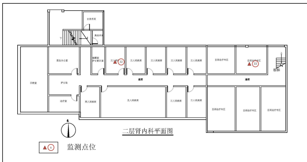
图 8-3 X-γ 辐射周围剂量当量率监测点位布设图三
