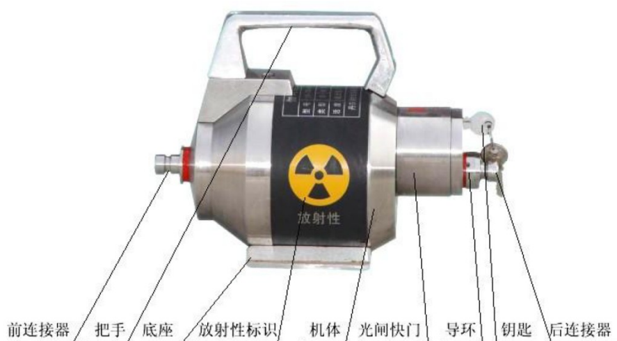
图 9-6 \gamma 射线探伤机典型源屏蔽容器外部结构组成图
