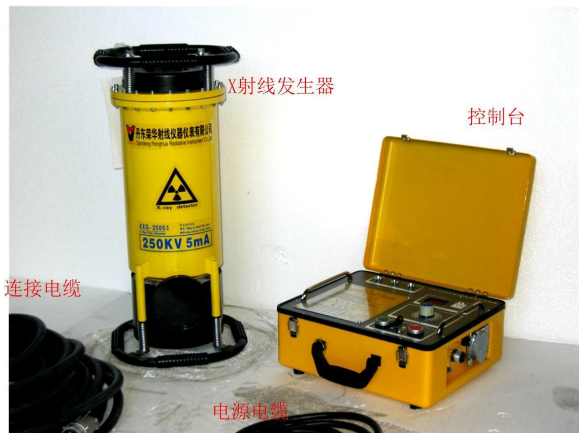
图9-1 探伤机设备外观及组成示意图
