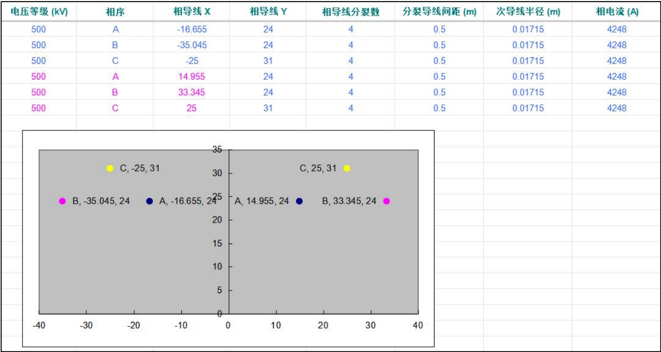
图 6-14 本项目拟建并行单回线路（三角排列）导线对地 24m 时电磁预测参数表
