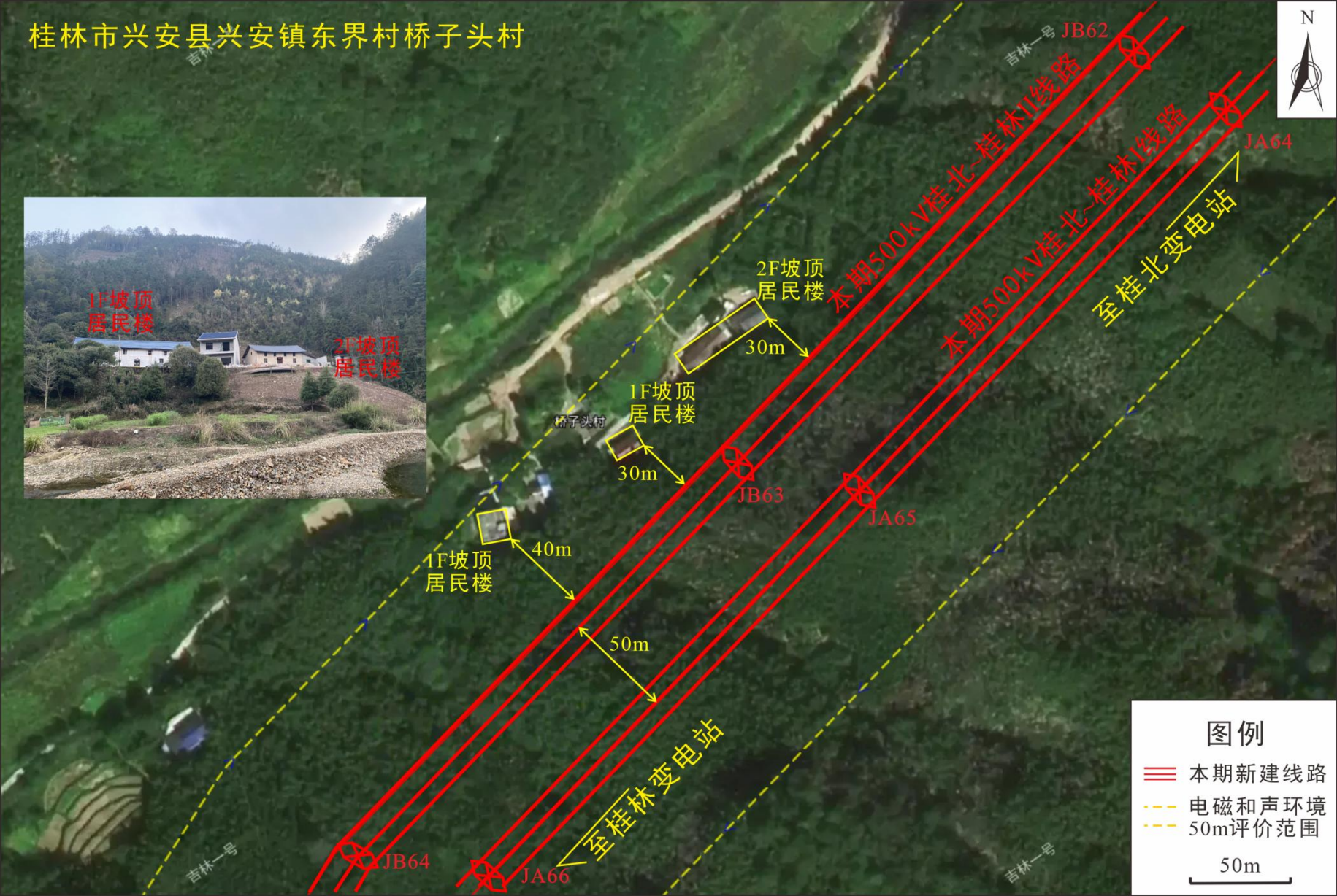
图 2-10 本项目拟建输电线路与环境敏感目标（东界村桥子头村）相对位置关系示意图
