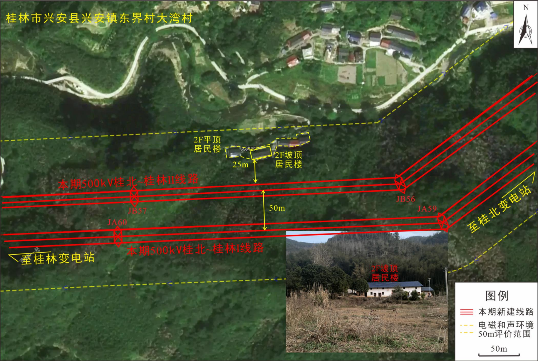
图 2-9 本项目拟建输电线路与环境敏感目标（东界村大湾村）相对位置关系示意图
