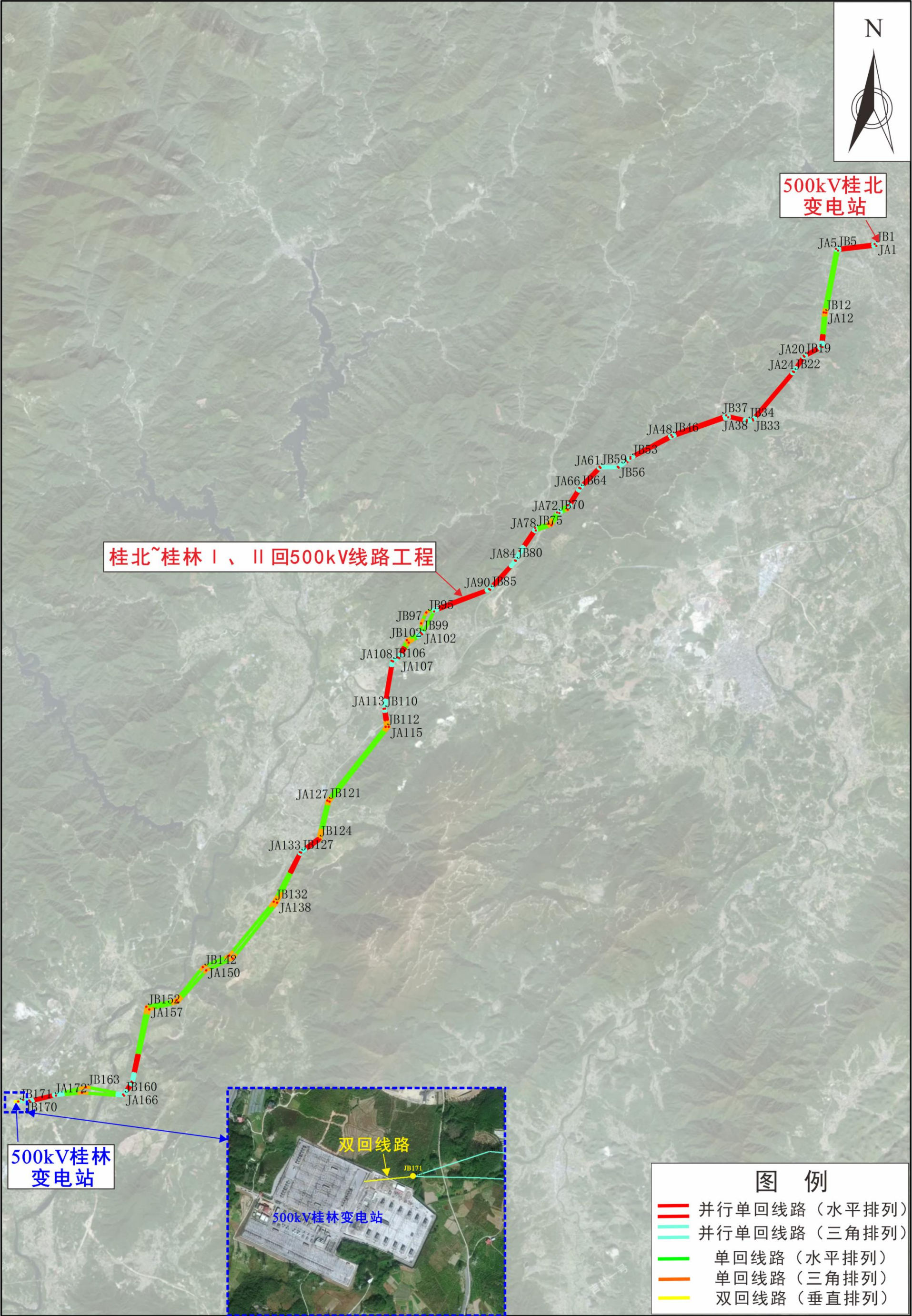
图 6-8 本项目输电线路全线架设方式一览表
