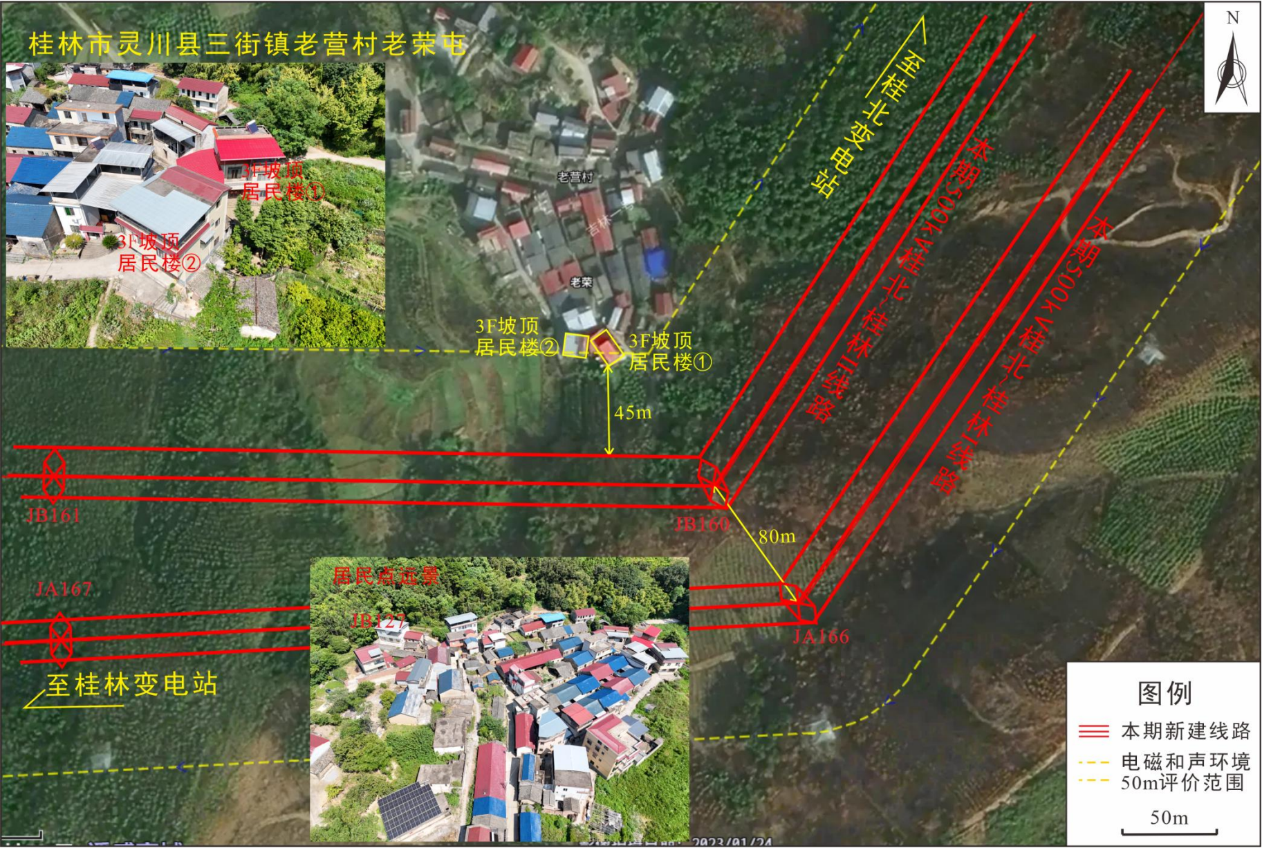
图 2-16 本项目拟建输电线路与环境敏感目标（老营村老荣屯）相对位置关系示意图
