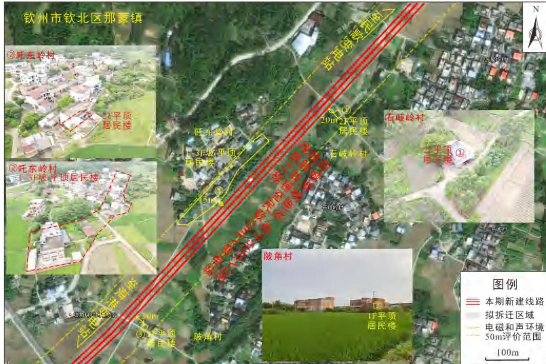
图 2-24 本项目拟建输电线路与环境敏感目标（跛角村石岐岭村、吒东岭村及跛角村）相对位置关系示意图
