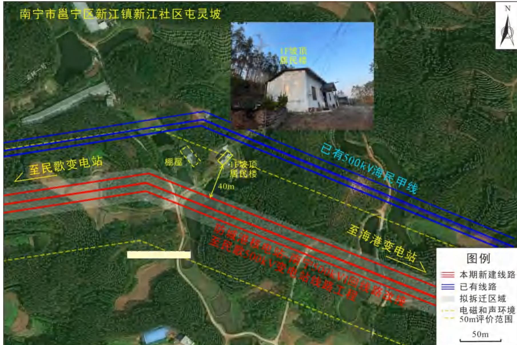
图 2-9 本项目拟建输电线路与环境敏感目标（新江社区屯灵坡）相对位置关系示意图
