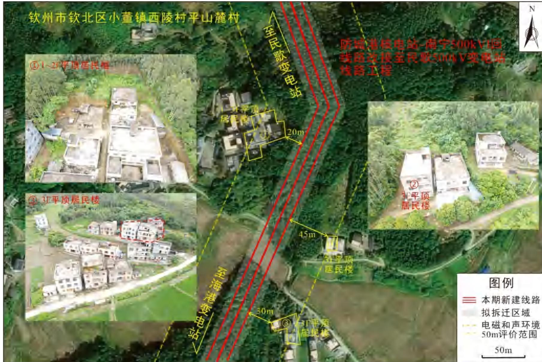
图 2-19 本项目拟建输电线路与环境敏感目标（西陵村平山麓村）相对位置关系示意图
