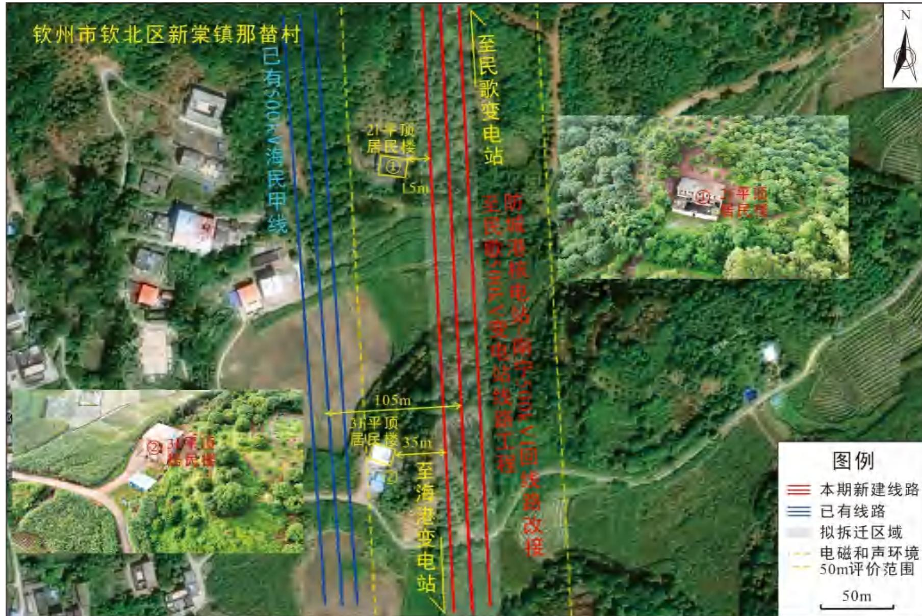
图 2-17 本项目拟建输电线路与环境敏感目标（那榃村）相对位置关系示意图
