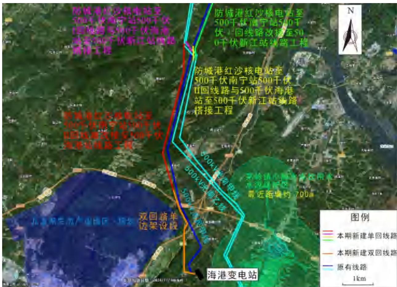
图 3-6 500kV 海港变电站北侧区域线路路径走向示意图
