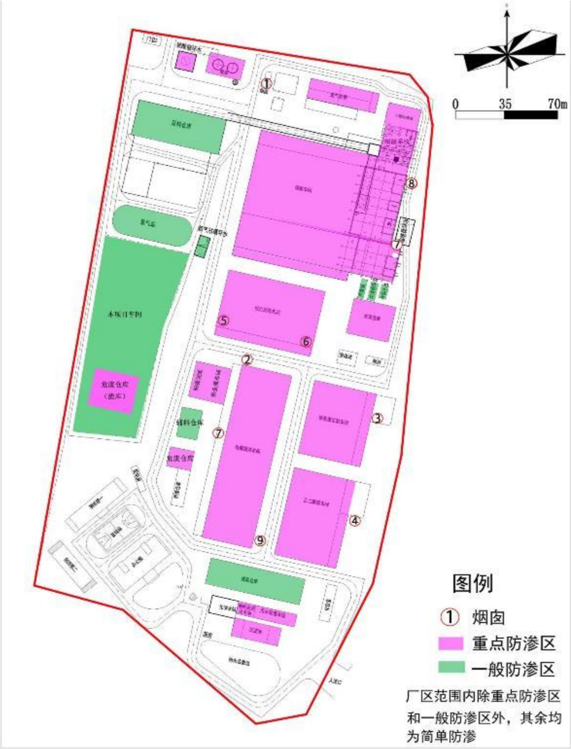
图 5.2.2 全厂地下水污染防控分区图
