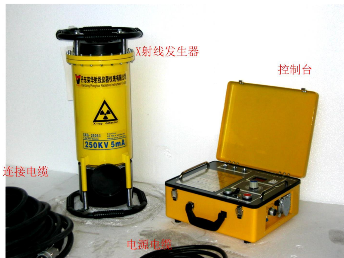
图 9-1 探伤机设备外观及组成示意图
