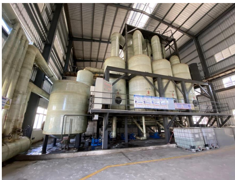
图 4.2-11 现有工程环保车间四效蒸发系统
