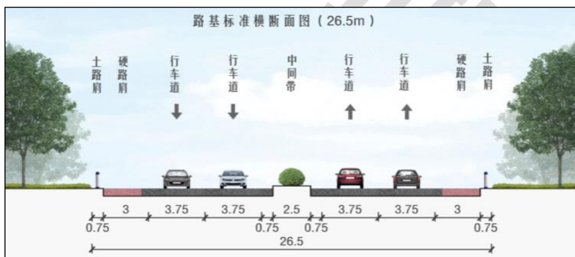
图 2.3-1 主线路基标准横断面图 (26.5m)
