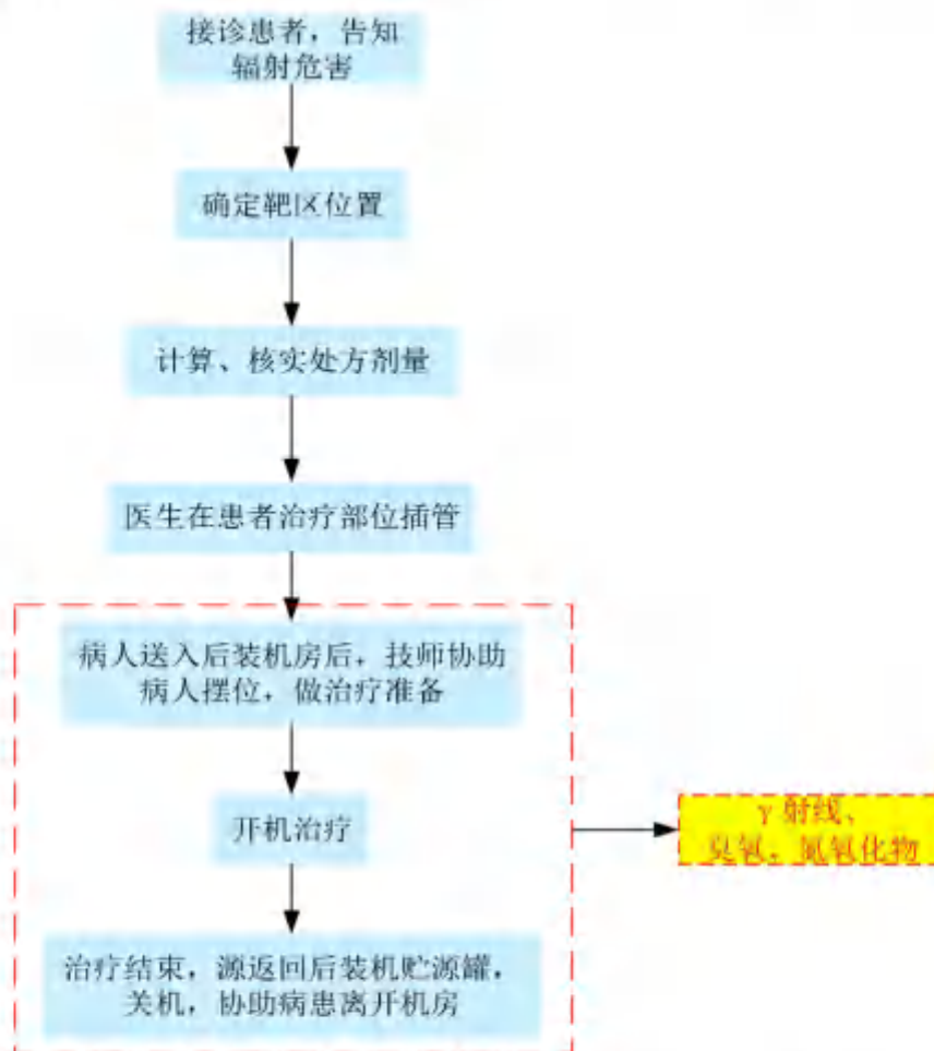
图 9-7 后装治疗机工作流程及产污环节图
