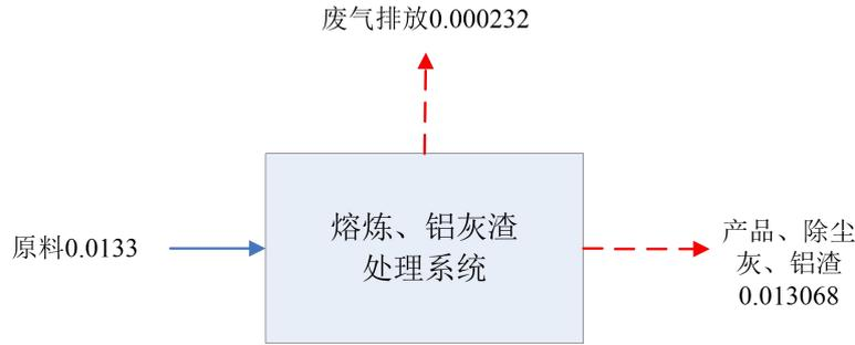
**图 3.7-6 工程铅元素平衡图 (t/a)**
