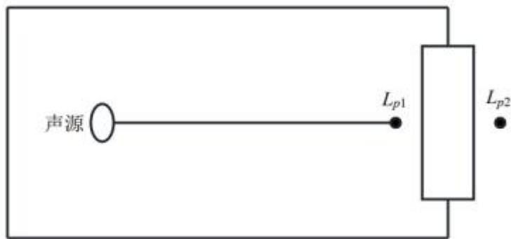
图 5.5-1 室内声源等效室外声源图例
