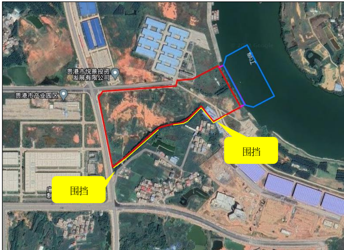
图5.1-1 活动式隔声吸声板围挡布置示意图
