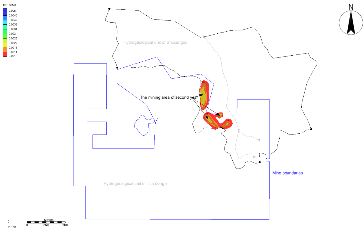
图4.5-57 非正常工况下矿体开采期间 Cd 预测结果（污染羽最低浓度值 0.001~0.005mg/L）
