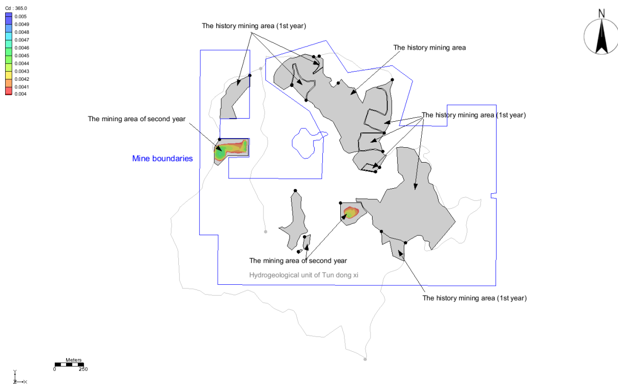
图4.5-50 非正常工况下矿体开采期间 Cd 预测结果（污染羽最低浓度值 0.004~0.005mg/L）
