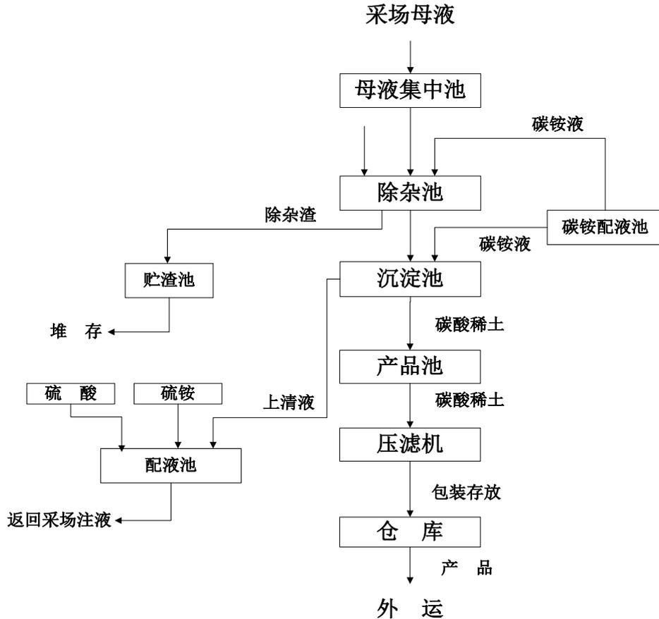
图2.1-4 现有工程母液处理车间工艺流程图
