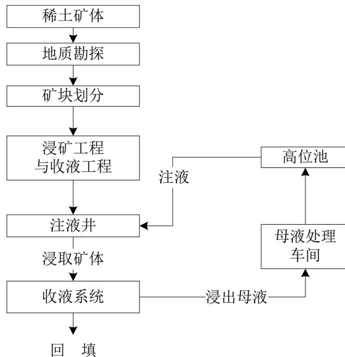
图2.1-3 现有工程原地浸矿工艺流程图
