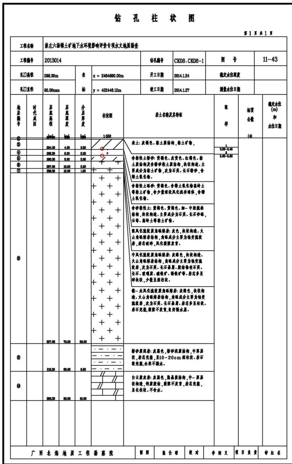
图3.1-11 CK08 钻孔柱状图
