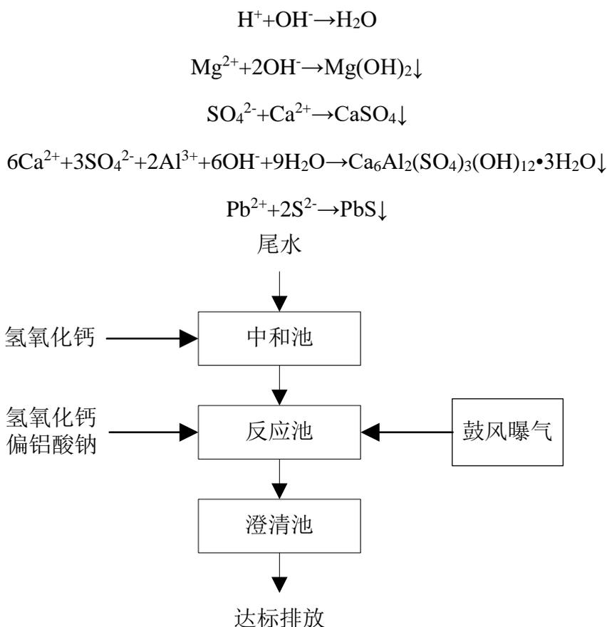
图6.3-1 末采矿块淋洗尾水处理工艺流程图
