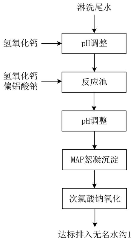
图2.2-5 技改后污水处理站工艺流程
