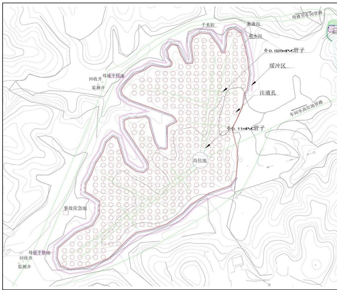
图2.2-6 赣州典型采场工程平面布局图
