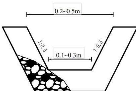
图6.4-2 避水沟断面的示意图
