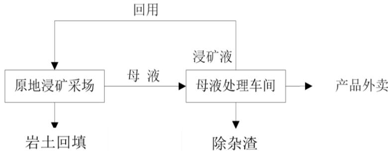
图2.1-2 整体工艺流程图
