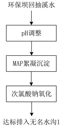
图2.1-5 现有工程污水处理站工艺流程
