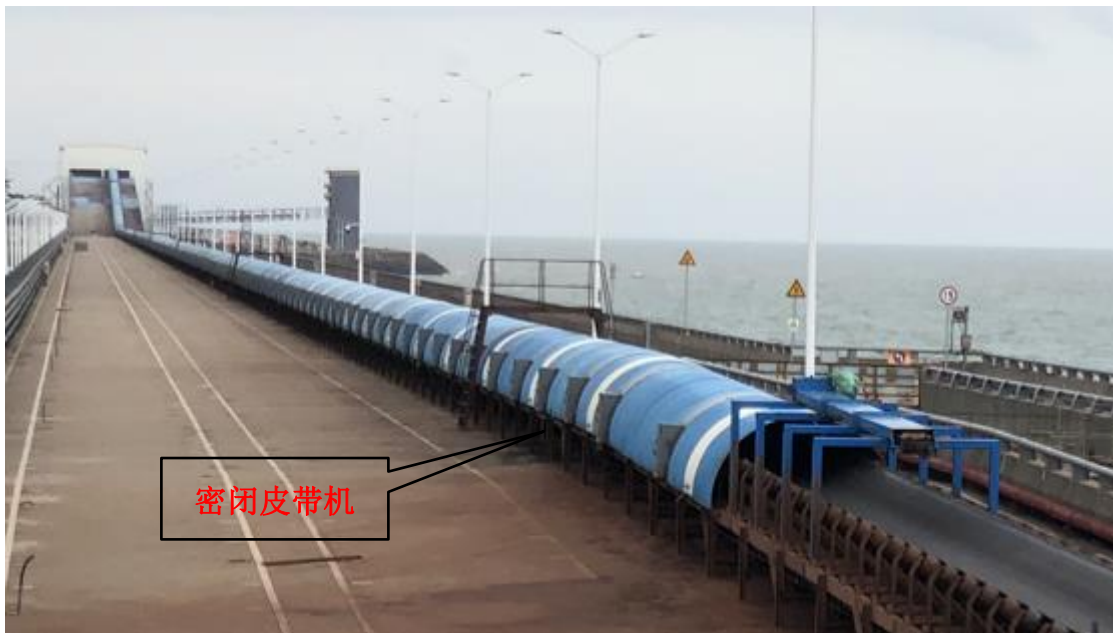
图 5.2-1 常见密闭皮带机示意图
