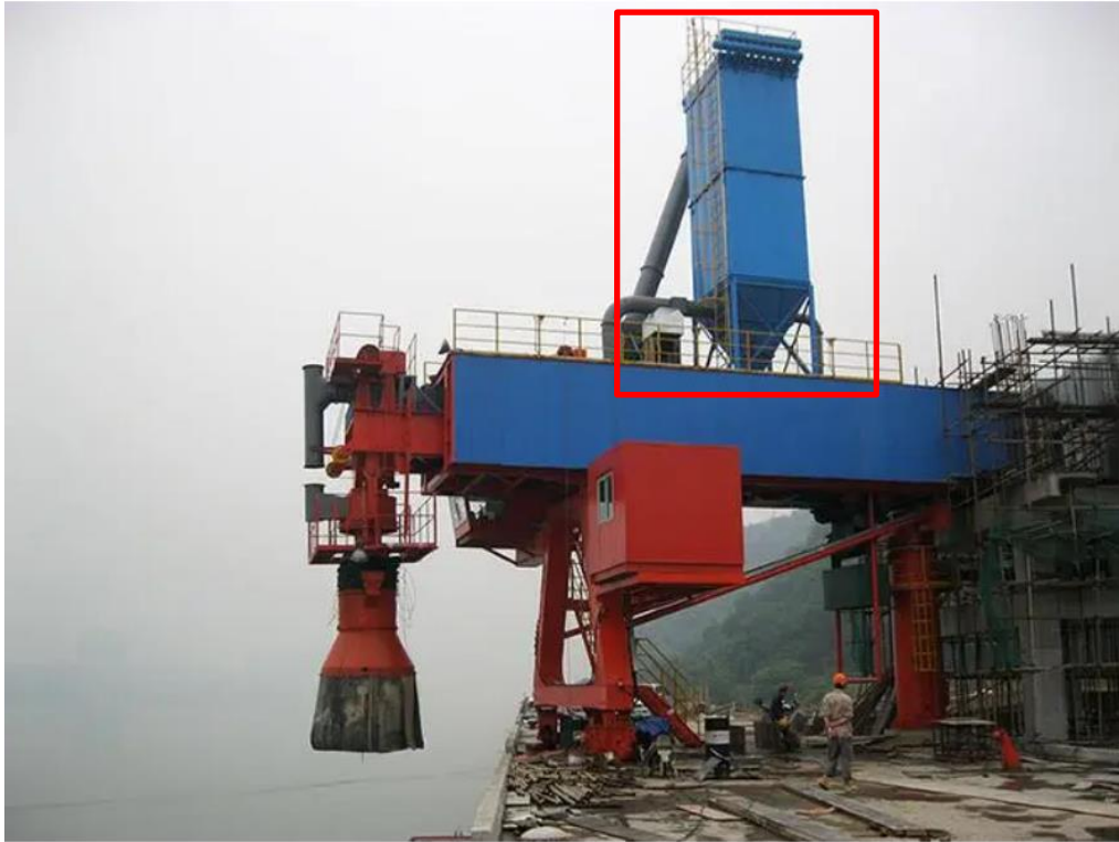
图 5.2-2 配备袋式除尘器的装船机示意图
