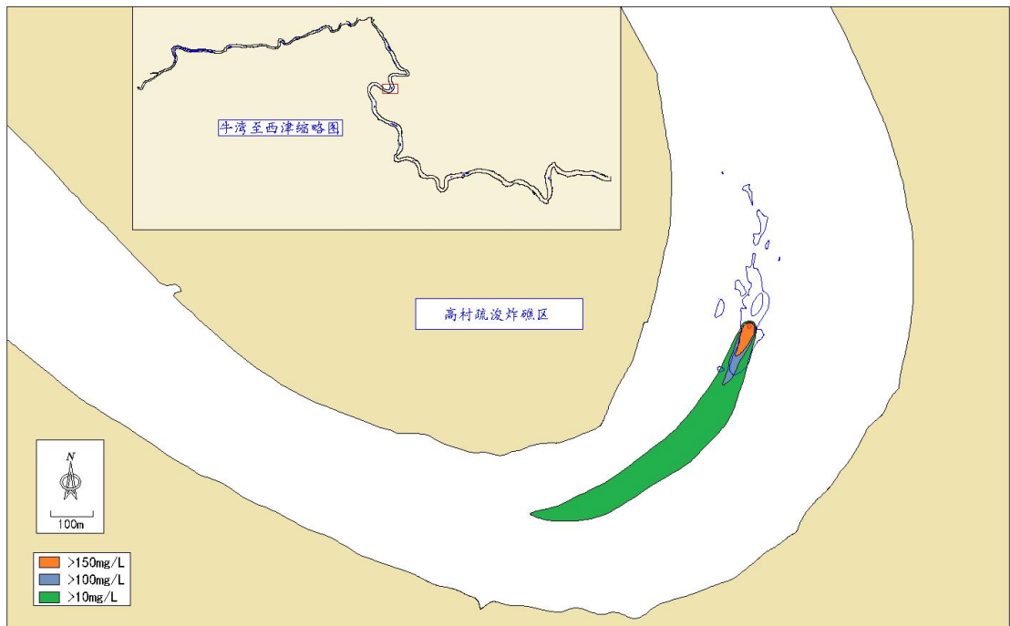
图 6.3-4 炸礁作业代表点悬浮物增量浓度影响范围（高村疏浚炸礁区）
