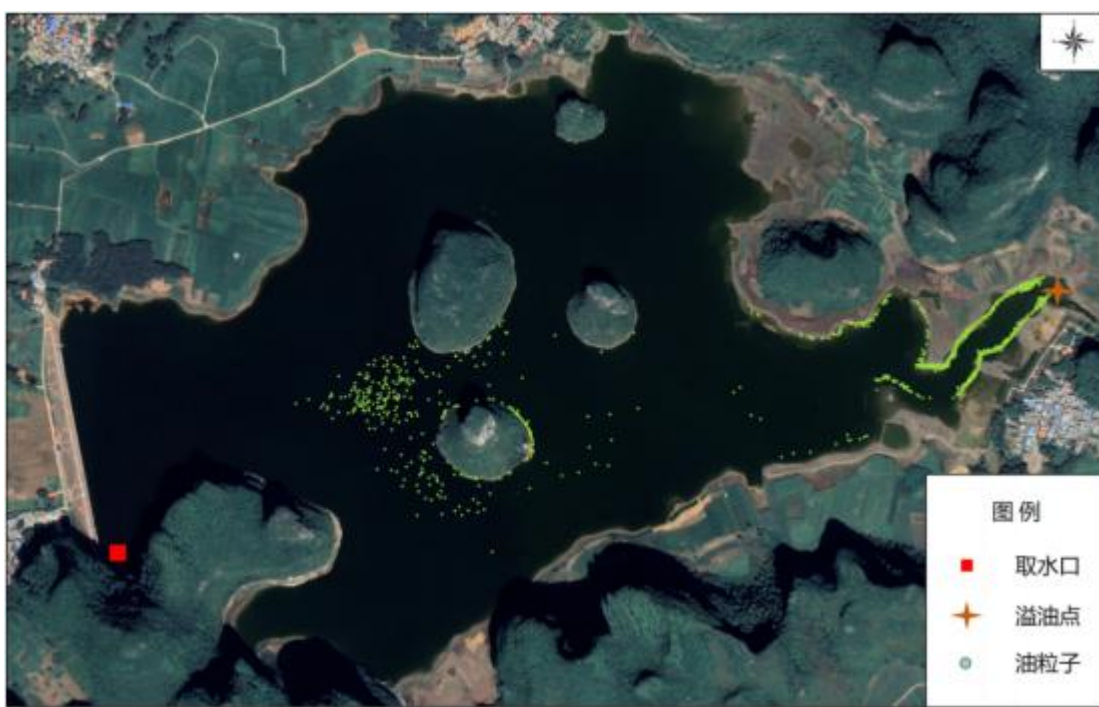
图 4.6-6 引洪道汇入口事故溢油 8h 后油粒子分布示意图
