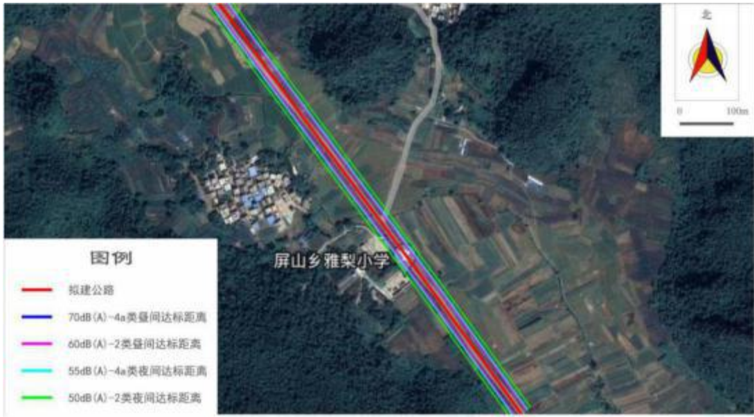
图 4.4-28 营运远期龙虎山连接线平面噪声等声线图
