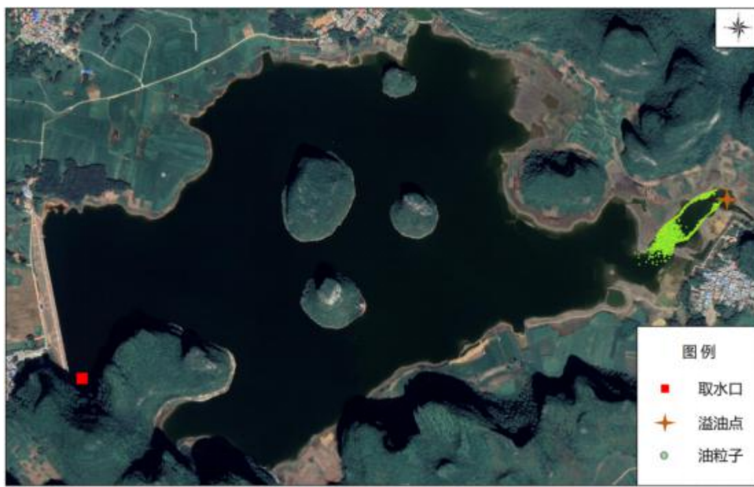
图 4.6-2 引洪道汇入口事故溢油 1h 后油粒子分布示意图
