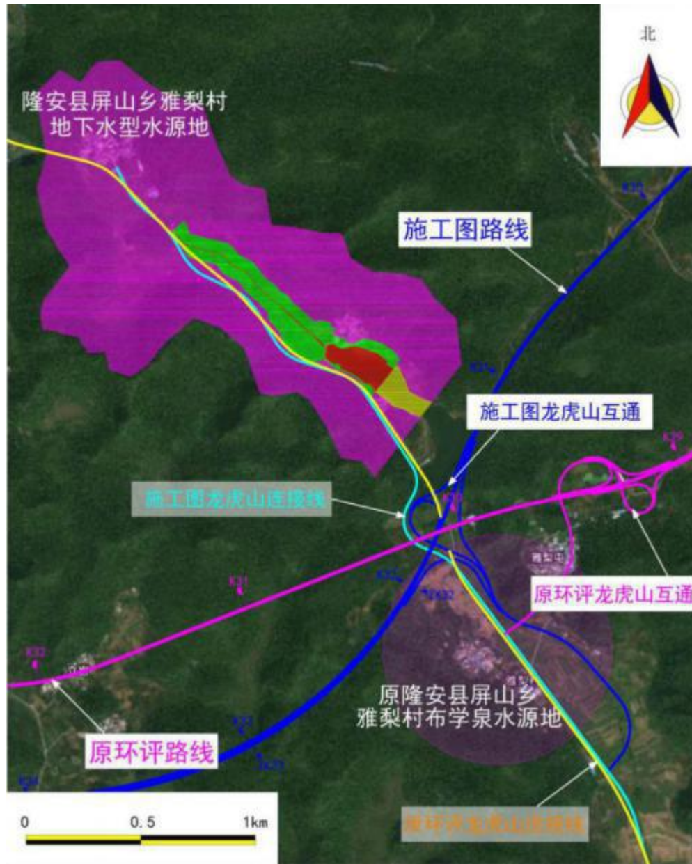
图 2.2-15 原环评及施工图路线与屏山乡雅梨村水源地关系示意图
