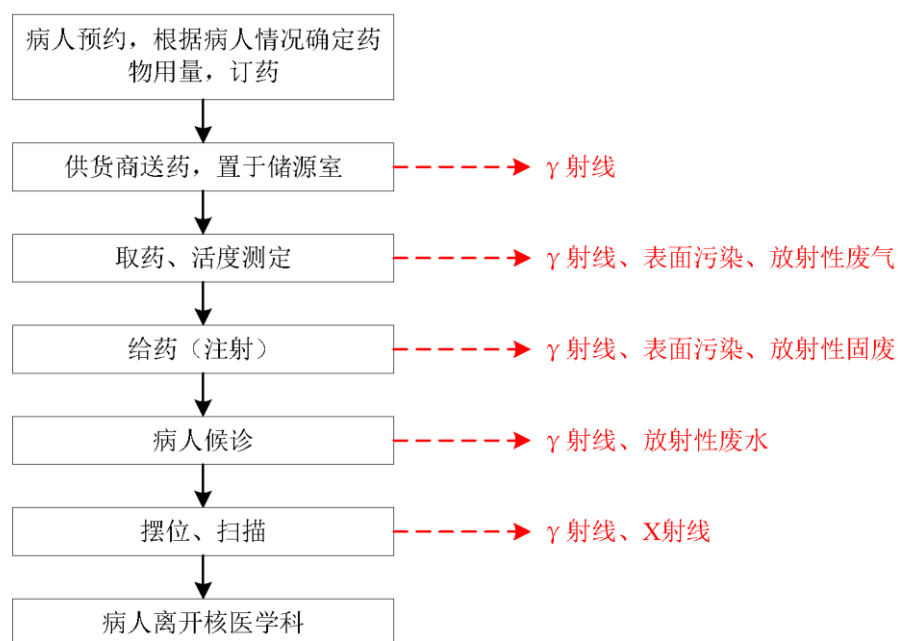
图 9.1-3 ^{99m}\text{Tc} 显像诊断项目工作流程及产污环节示意图
