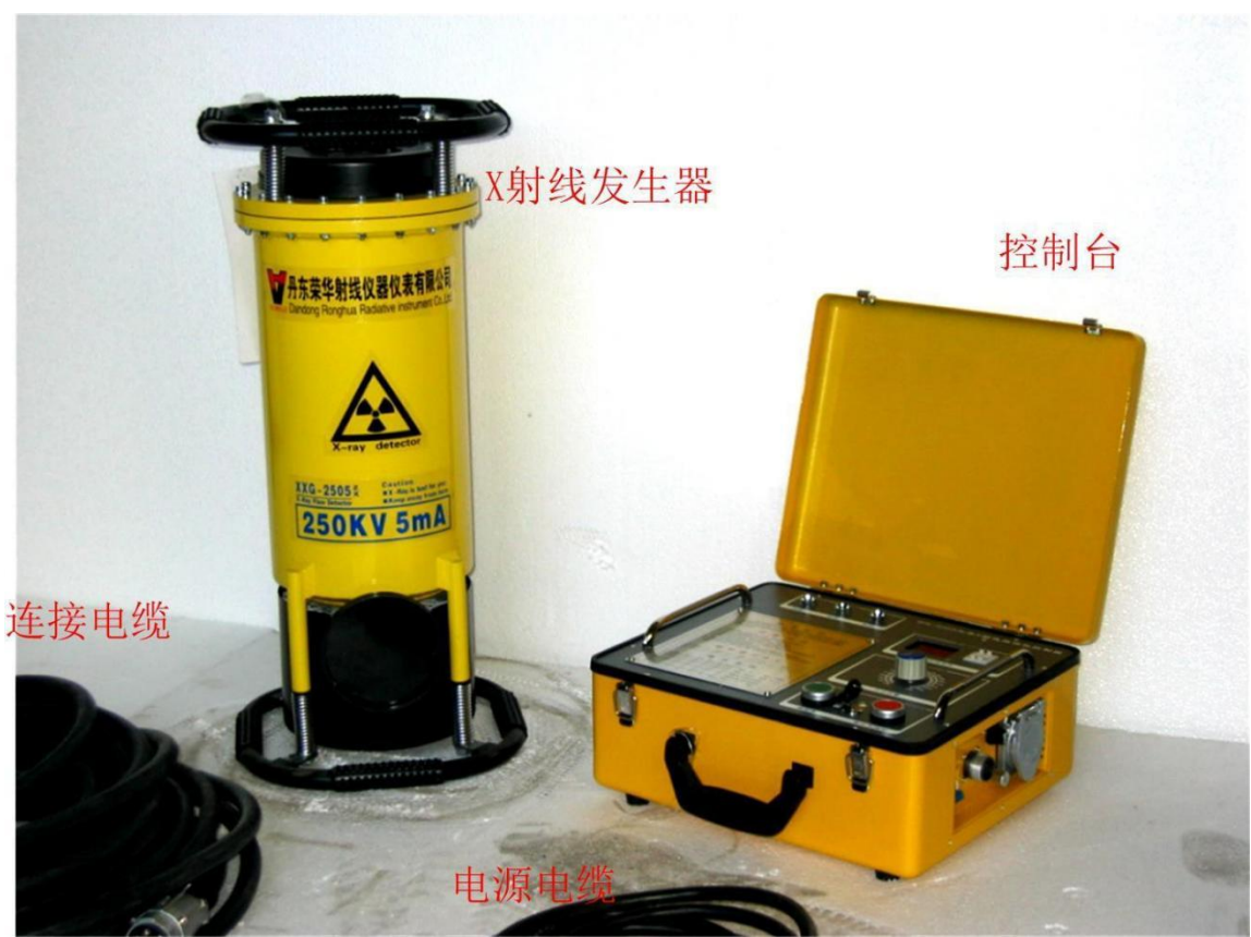
图9-1 探伤机设备外观及组成示意图
