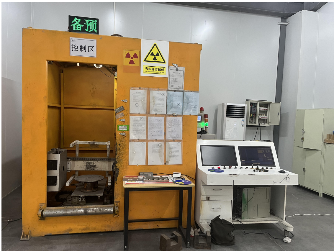
图 1-9 拟搬迁探伤机以及铅房现状
