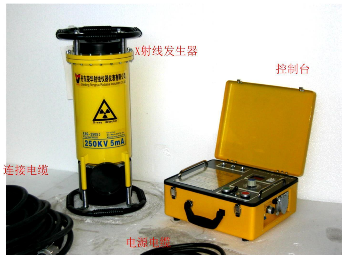
图 9-1 探伤设备外观及组成示意图
