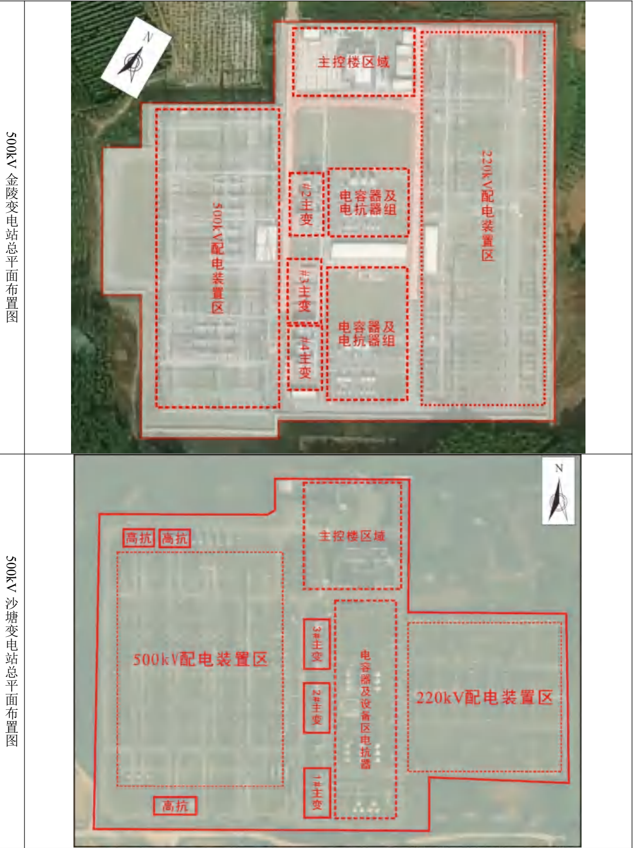
图 6-1 500kV 金陵变电站和 500kV 沙塘变电站平面布置对比图
