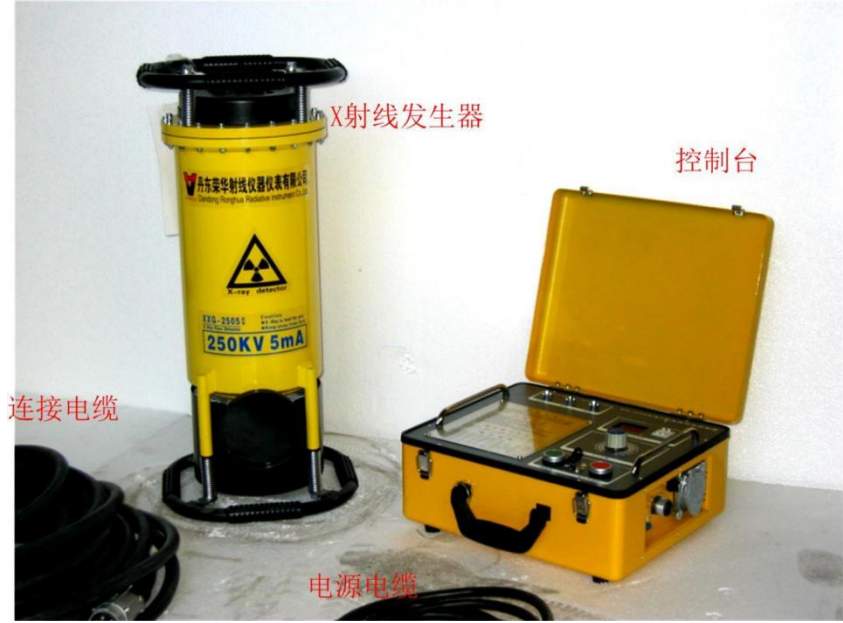
图 9-1 探伤设备外观及组成示意图
