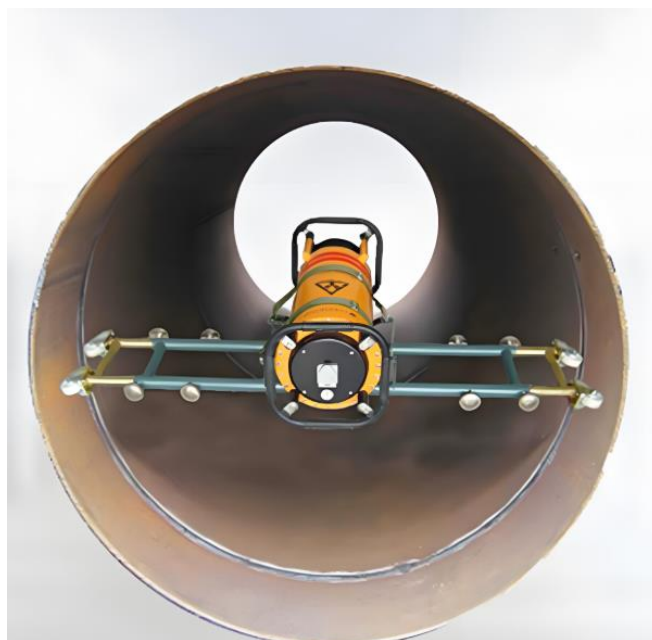
图 9-7 周向机的安装固定示例
